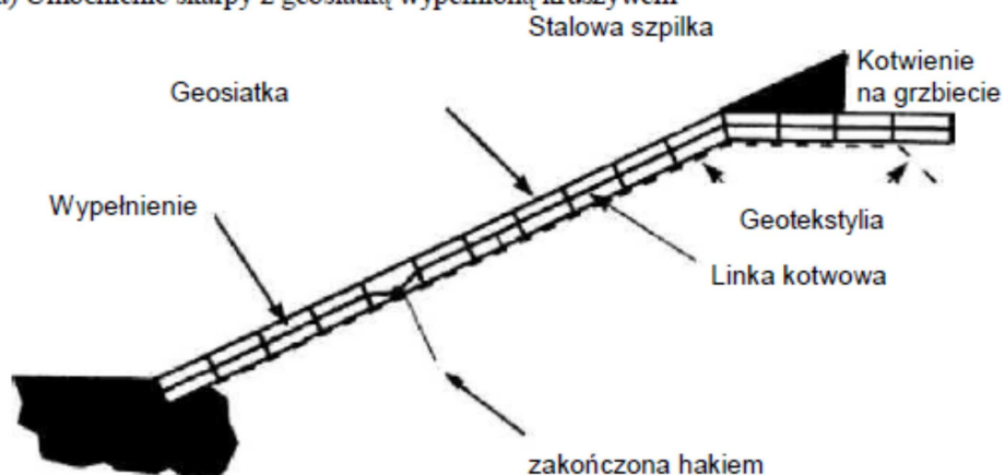
Rys. 12. Umocnienie skarpy geosiatką komórkową
